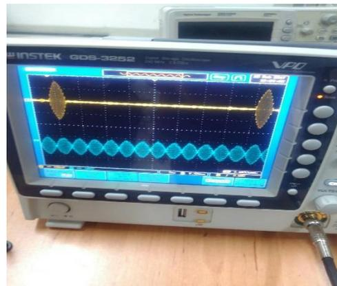
Gambar 4.2 Output salah satu antenna *sideband*
